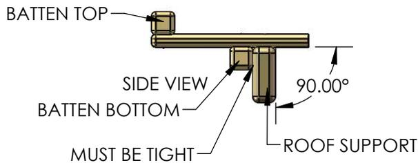
2: MAKE SURE THE ANGLED ENDS ARE FLUSH, AND THE BATTEN BOTTOM IS TIGHT AGAINST THE INSIDE FACE OF THE ROOF SUPPORT.
