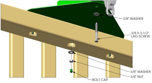
STEP 25: LEVEL SWING BEAM 1: PLACE A LEVEL ON TOP OF THE SWING BEAM AND ADJUST THE BEAM LEGS IN OR OUT AS NEEDED TO MAKE THE SWING BEAM LEVEL. **IMPORTANT NOTE:** THE LEGS ARE **DESIGNED TO ACCOMODATE SWING BEAMS** ON UNEVEN GROUND (DOWN SLOPE). THEY ARE LONGÉR THAN REQUIRED. IF YOUR GROUND IS RELATIVELY LEVEL, YOU MAY NEED TO EITHER A) SHORTEN THE END OF THE LEGS; B) DIG IN BOTH LEGS WHERE THEY MEET THE GROUND, OR C) BEND THE LEGS **OUT SLIGHTLY TO MATCH YOUR GRADE**
