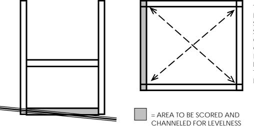
THE DIAGONAL MEASUREMENTS SHOULD BE THE SAME FROM CORNER POST TO CORNER POST. IF NOT, ADJUST FORT SO THAT THE DISTANCE IS EQUAL.
